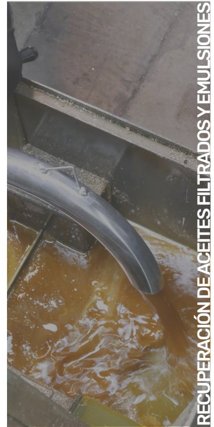
ASPIRACIÓN Y SEPARACIÓN DE ACEITE Y VIRUTAS
